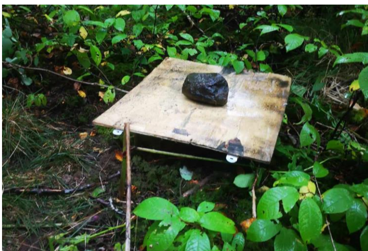
Figur 2. Eksempel på en av fellene. Under platen er de nedgravde bøttene, jord og mose er lagt rundt kanten av fellen for å simulere de naturlige omgivelsene.
